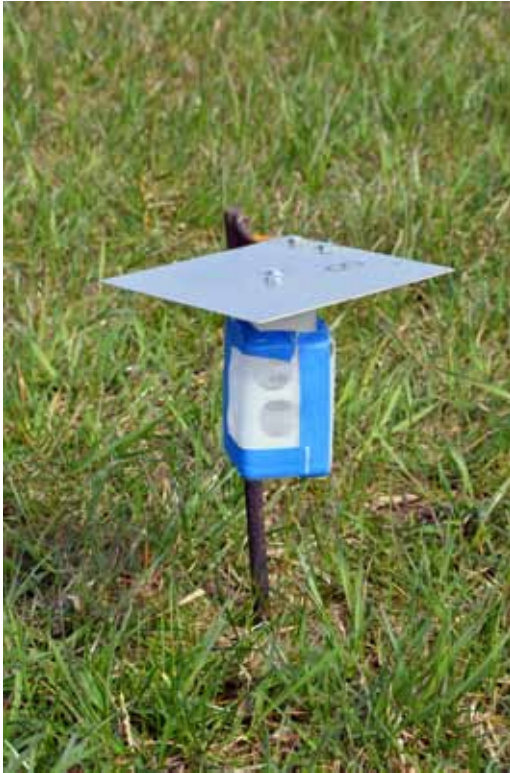
Universitetet i Kiel har foretaget ammoniakfordampningsmålinger ved alle udbringninger i de to forsøg med andetårs effekten. Her står måleren i en parcel. (Foto: Annette V. Vestergaard, Videncentret for Landbrug).
