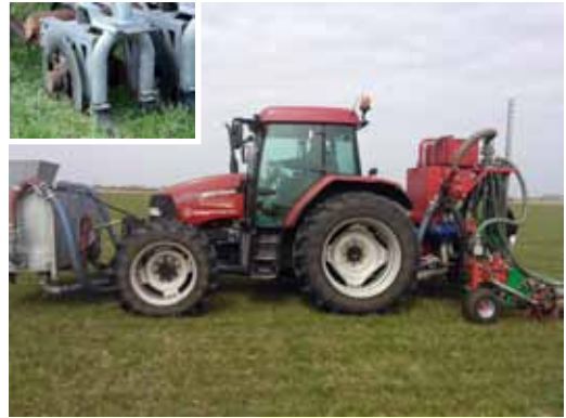
Udbringning af gylle med udstyr fra Aarhus Universitet. Nedfældning på 34 cm afstand kræver dyb nedfældning ved udbringning af 44 ton pr. ha. (Fotos: Annette V. Vestergaard, Videncentret for Landbrug).
